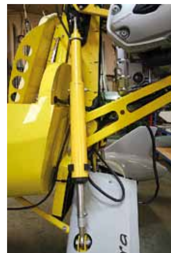
La suspension utilise des tampons élastomères.
