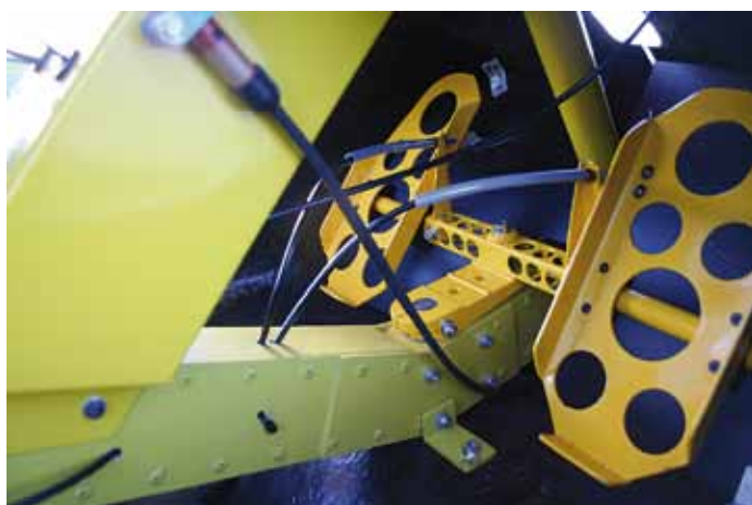
Les palonniers sont réglables en 3 positions.
