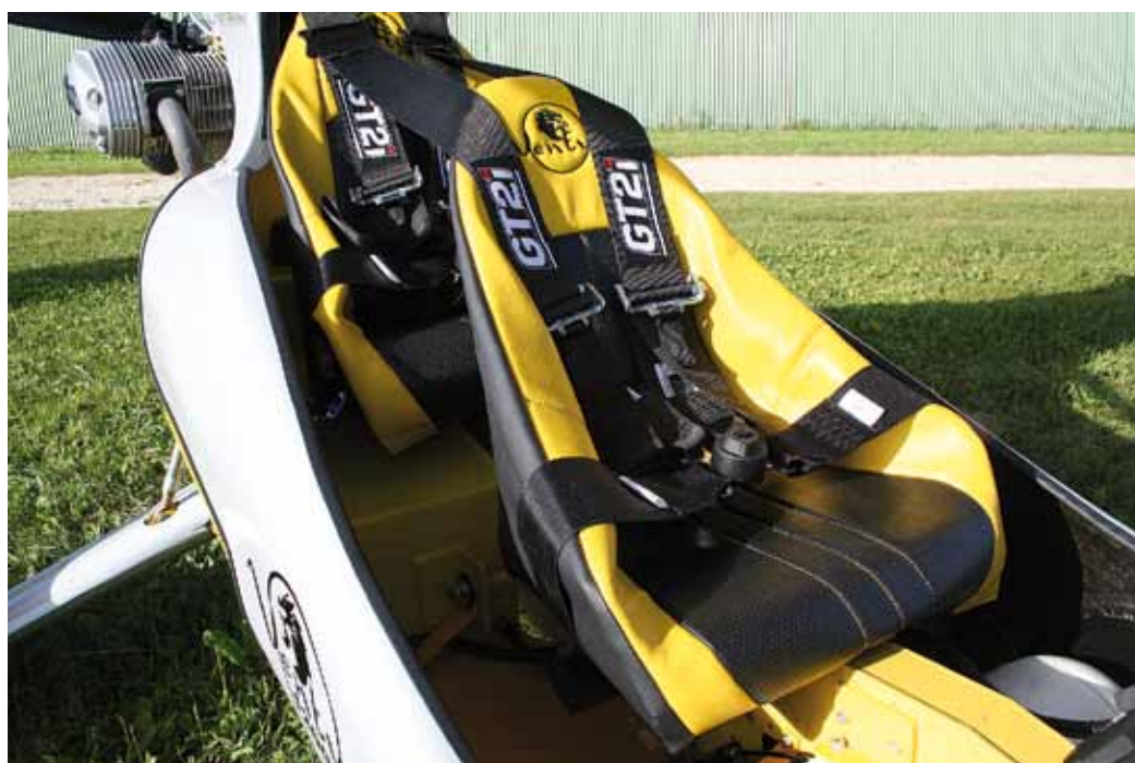
Les deux places sont équipées de harnais 4 points.
